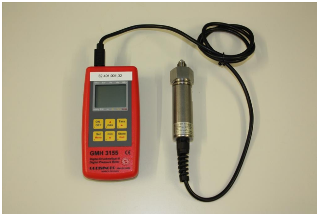
Abbildung 9: Digital-Druckmessgerät (GMH 3144, Greisinger Elektronik)
