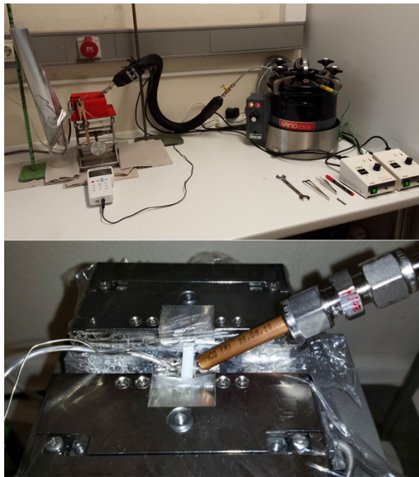
Abbildung 13: Erweiterter Versuchsaufbau auf Basis des 5 kN Biegemoduls mit Autoklav, Heizschlauch und Dampf Düse.
