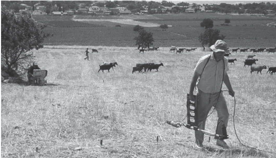
Abb. 3 Prospektion mit dem Absorptionsmagneto- meter Varian-Scintrex (H. Becker).
