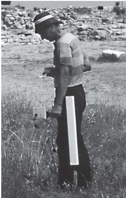
Abb. 2 Prospektion mit dem Fluxgate-Gradiometer Geoscan FM 36 (H. G. Jansen).
