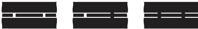
Abbildung 4.3: Verschiedene Resonator-Geometrien, schwarze Flächen entsprechen leitenden Strukturen. Links: \lambda/2 -Resonator mit zwei Unterbrechungen. Mitte: \lambda/4 -Resonator mit einem Kurzschluss zur Ground Plane. Rechts: \lambda/2 -Resonator mit zwei Kurzschlüssen zur Ground Plane.
