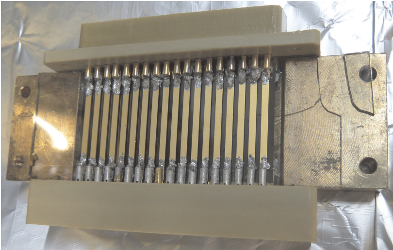
Abbildung 3.17: Thermoanker aus einem Saphirchip mit Goldleiterbahnen. Im eingebauten Zustand ist auf der Oberseite eine zweite OFHC-Klammer verbaut, die den thermischen Kontakt sicherstellt. Rechts ist der Riss im Chip zu sehen, der durch thermische Verspannungen entstanden ist.
