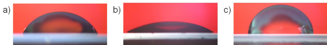
Abbildung 5-4 Oberflächenfunktionalisierung der Vergussformen
