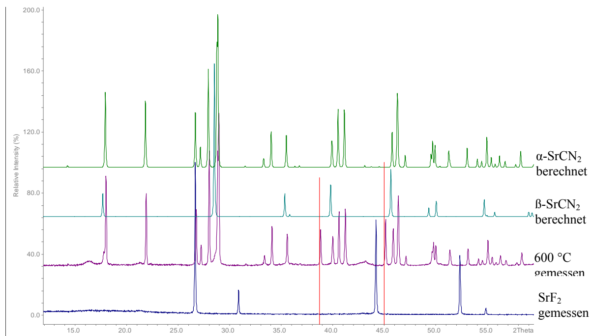
Abb. 5.5.3.1: Berechnete Diffraktogramme von \alpha - \text{SrCN}_2 und \beta - \text{SrCN}_2 im Vergleich mit einem Pulverdiffraktogramm des Reaktionsproduktes das gemäß Reaktionsgleichung 5.5.3 entstanden war, zum Vergleich ist ein Pulverdiffraktogramm von \text{SrF}_2 gegeben (rote Linien: Pulverdatenbankeintrag [45-1460] für \text{LiF} ).
