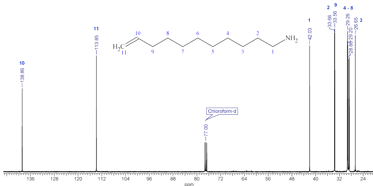
Abbildung 3.3: ^{13}\text{C}\{^1\text{H}\} -NMR-Spektrum ( \text{CDCl}_3 , 100,62 MHz) von 10-Undecenylamin 4b .
