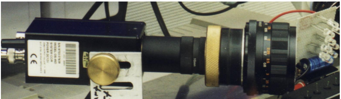
Abbildung 1.9: Video-Kamera mit Zwischenringen (gelber Ring und schmalere Ringe links davon) zwischen Linse (rechts) und Kamera-Gehäuse (links) für Nahaufnahmen von Arabidopsis-Keimlingen. Ganz rechts erkennt man einen Satz Infrarot-Leuchtdioden, mit denen die Keimlinge beleuchtet werden
