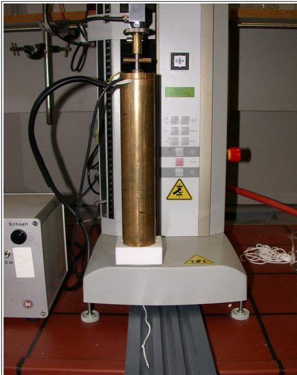
*Abbildung 7.2.5: Aufbau von Kolben Extruder und Materialprüfmaschine*
