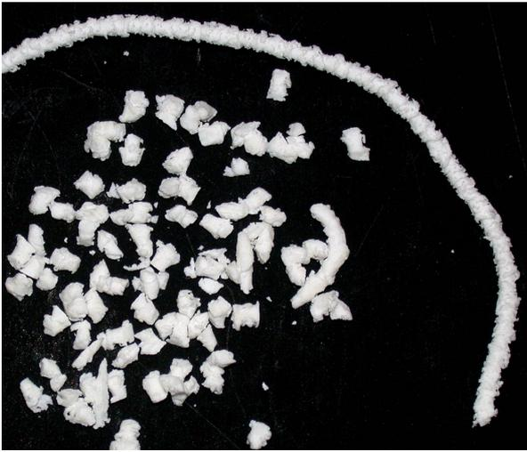
**Abbildung 5.4.5:** Strangbrüche und Pellets mit zerklüfteter Oberfläche 70 % THEO und 5 % TEC
