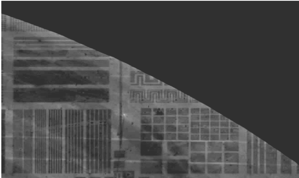
Abb. 5.51: Softlithographisches Printing von LIPODOT-Verbindungen
