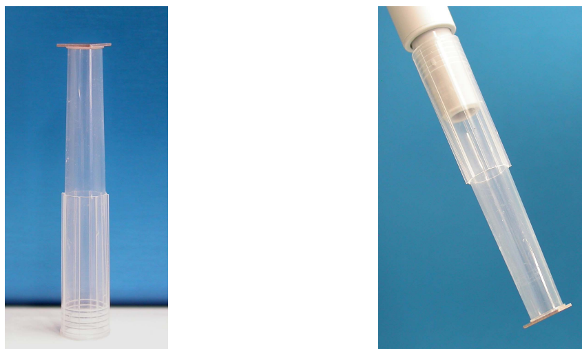
Abbildung 10: abgeschnittene Pipettenspitze mit aufgeschmolzener Partox-Membran (Partox-Tip).
