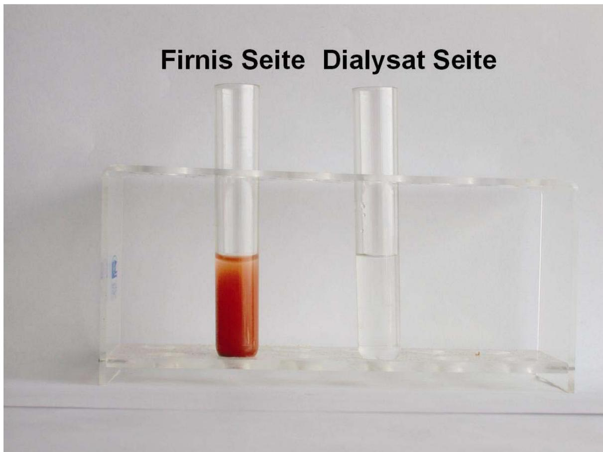
**Abbildung 15** Mögliche Permeation von Ammoniumionen durch verschiedene Membranen bestehend aus Firnis / Gaze / Dialyseschlauch
