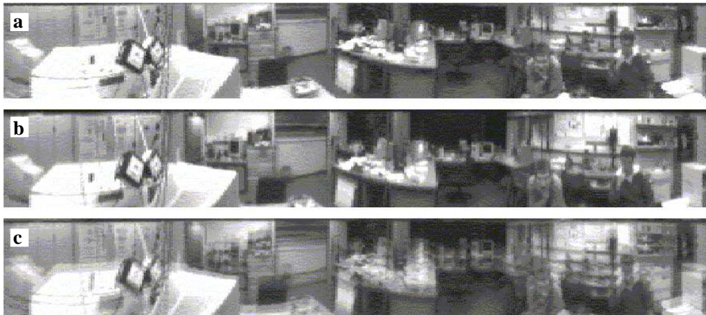
Abbildung 3.8: Mit Hilfe von Gleichung (3.99) transformierte Bilder des panoramischen Stereobildes aus Abbildung 3.4 (Auflösung ist jeweils 360 \times 100 Pixel, für die Darstellung wurde in x -Richtung um Faktor 2 skaliert). a: Bild des oberen Spiegels. b: Bild des unteren Spiegels. c: Überlagerung von a und b : Korrespondierende Bildbereiche weisen nur vertikale Verschiebungen auf, so dass die Bestimmung der Disparitäten auf eine eindimensionale Maximierung der lokalen Bildkorrelation reduziert werden kann.
