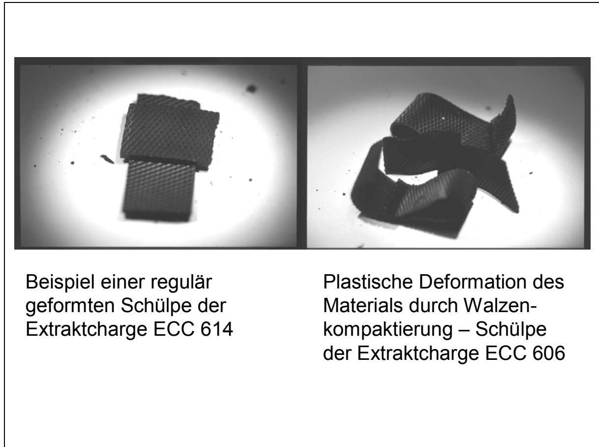
Abb. 7-2 Unterschiede im Kompaktierverhalten verschiedener Extraktchargen von Eschscholtzia californica Cham.-Trockenextrakt am Beispiel der unterschiedlich ausgebildeten Schülpfen
