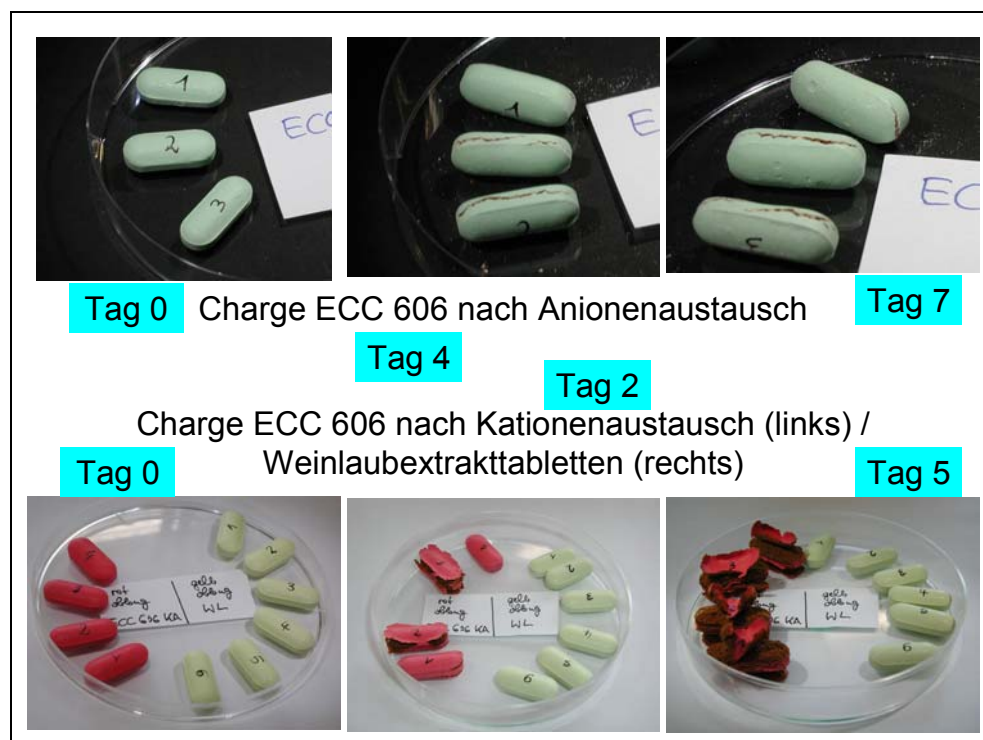
Abb. 8-5 Vergleich der „Stabilität“ von Extraktfilmtabletten der Charge ECC 606 nach Entfernung der Anionen bzw. Kationen unter Lagerung bei 25 °C und 60% r.F.
