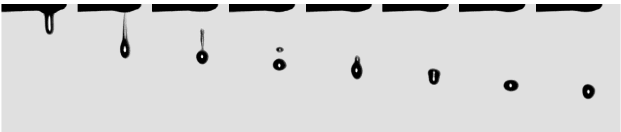
Abbildung 4-34: Stroboskopische Aufnahme der Tropfenemission einer Proteinelösung mit c_{\text{Protein}} = 100 \mu\text{g/ml} .
