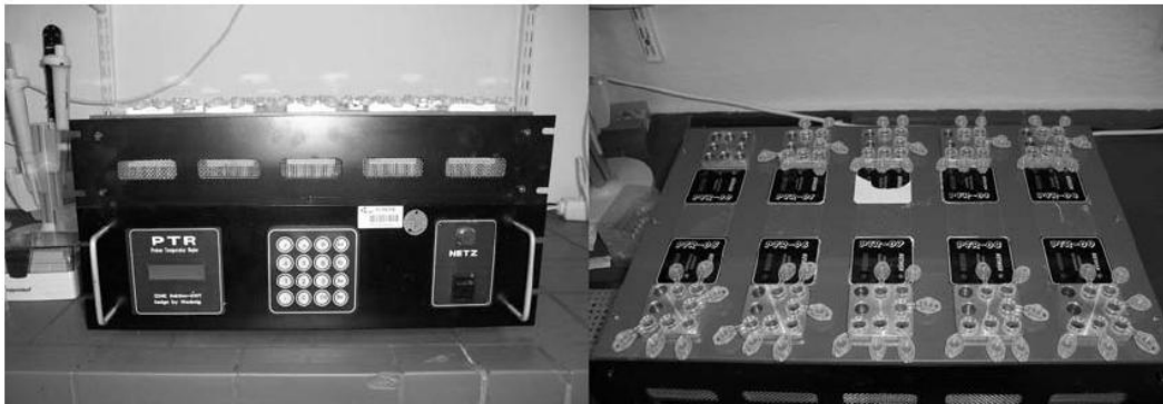
Abbildung 2-2: Das PTR-Gerät (Probentemperaturgerät) des Zentrums für Zahn- Mund und Kieferheilkunde (ZZMK) der Universitätsklinik Tübingen (Design by Wedenig).
