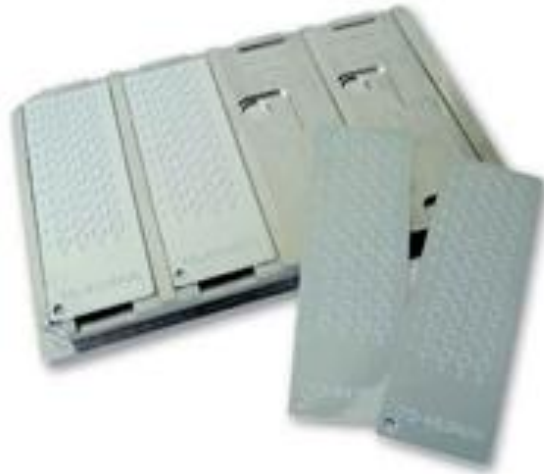
Abb. 9: FlexiMass-Metallträger für MALDI-TOF-MS-Messungen. Probenmaterial und Matrix werden auf die markierten Felder des Trägermaterials aufgetragen und kokristallisiert (aus: http://www.shimadzu.eu ).
