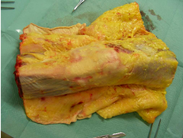
Abbildung 2-2: Hautpräparation eines Knies für das spätere Anbringen der Sehnenklammern und den Einspannvorgang im Kniekinemator benötigt wurden.
