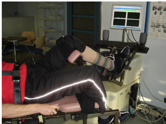
Abbildung 13: Standardisierte Messposition am Cybex NORM mit Fixation des Probanden an der Fußplatte, am Oberschenkel und mit Gurten an Oberkörper und Becken
