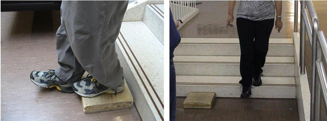
Abbildung 10: Treppentest mit halber Stufe (links) und ganzer Treppenstufe (rechts)
