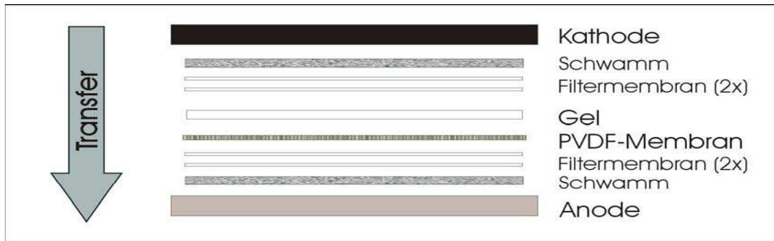
Abb 2: Schichtaufbau für das Semidry-Blotting
