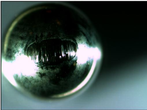
**Abbildung 65 Versuch 2 CoCr- Stempel 1, nach Verschleiß, Vergrößerung 10x**
