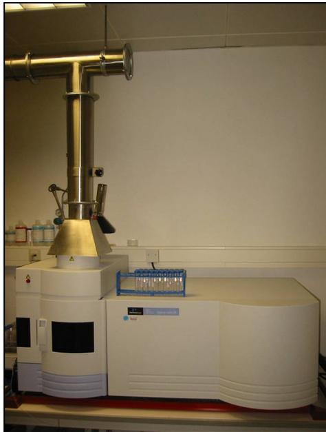
Abbildung 22 Emissionsspektrometer ICP- OES (Optima 4300, Perkin Elmer)
