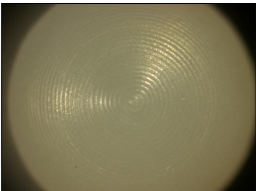
Abbildung 59 PE- Stempel Ausgangszustand, Vergrößerung 10x
