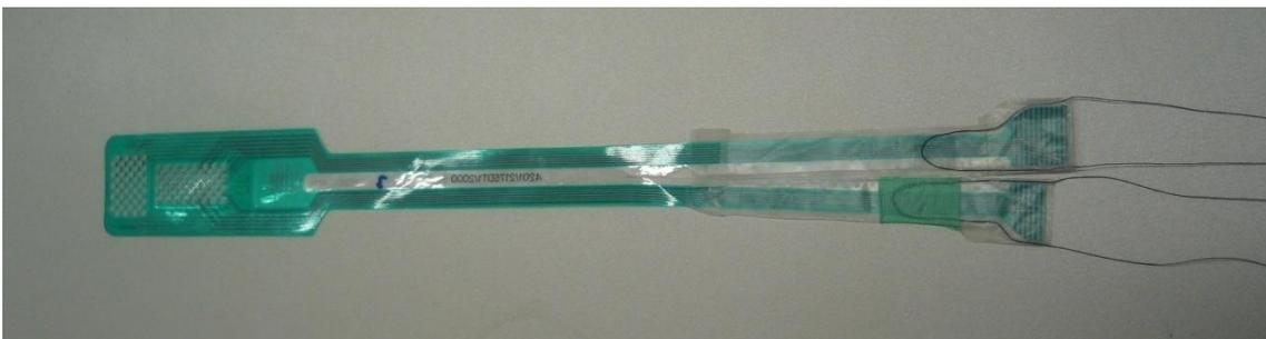
Abb. 8 zerteilte Druckmessfolie, erneut versiegelt und mit Fixierungsfäden versehen.
