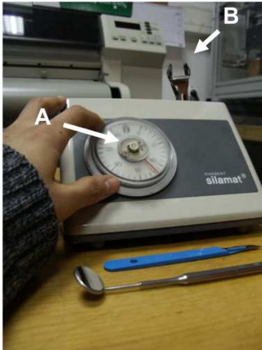
Abbildung 24: Das Hochfrequenz-Mischgerät silamat® ; Das Drehrad (A) dient der Einstellung der Zeitschaltuhr; Die Kapsel wurde in die mit einem Pfeil markierte Vorrichtung (B) eingeklemmt (aus [130])
