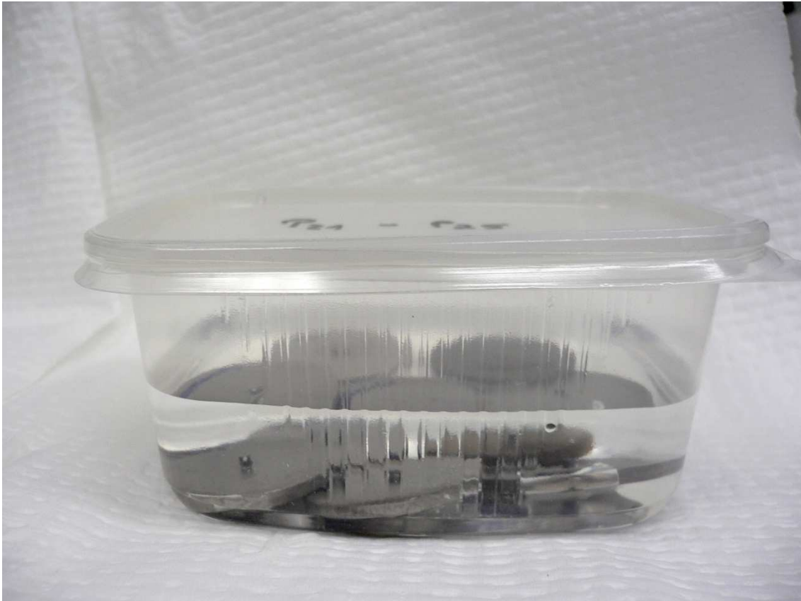
Abbildung 28: Darstellung des Plastischälchens mit beschriftetem Deckel, gefüllt mit destilliertem Wasser, in welchem 5 Prüfkörper lagern.
