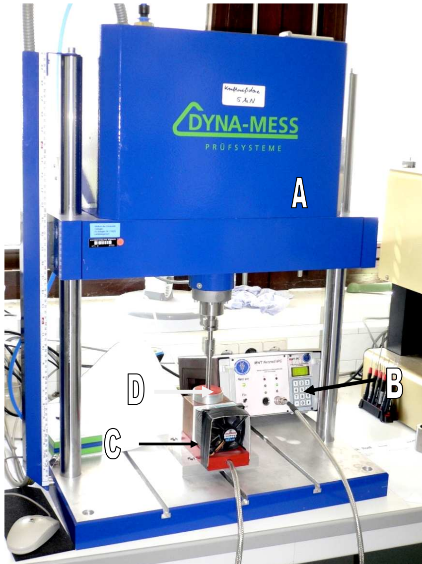
Abbildung 31: Aufbau des dynamischen Prüfsystems (A). Der Temperaturregler (B) sorgte während des gesamten Versuchs für eine konstante Temperatur von 37°C, die über den Kupferblock (C) auf den Edelstahlzylinder, die darin befindliche Flüssigkeit und so auf den Prüfkörper übertragen wurde. Der Stempel (D) wurde durch den roten Führungsteller in seiner Bewegungsrichtung stabilisiert.
