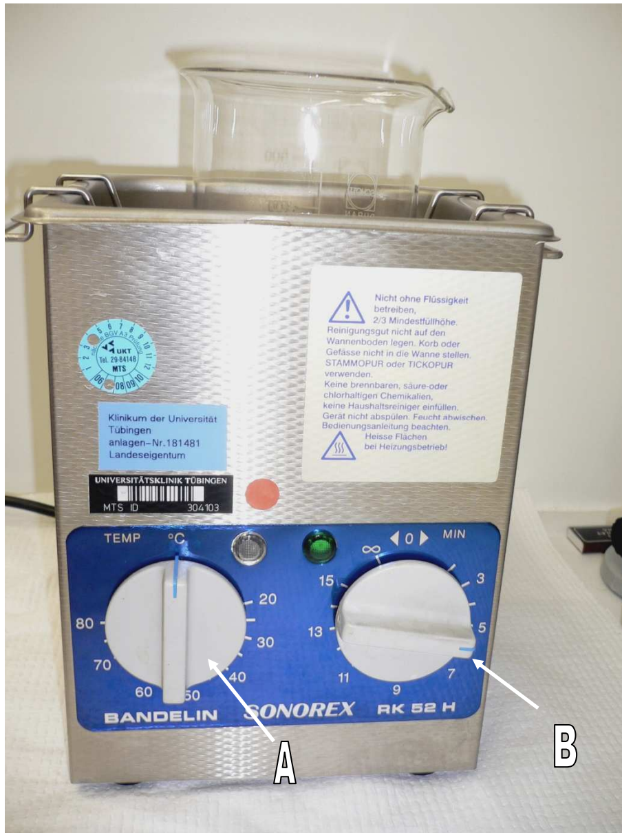
Abbildung 13: Darstellung des verwendeten Ultraschallgerätes, in dem sich das mit Ethanol gefüllte Becherglas mit den Prüfkörpereinzerteilen befindet. A = Temperaturregler; B = Zeiteinstellung (5min.)
