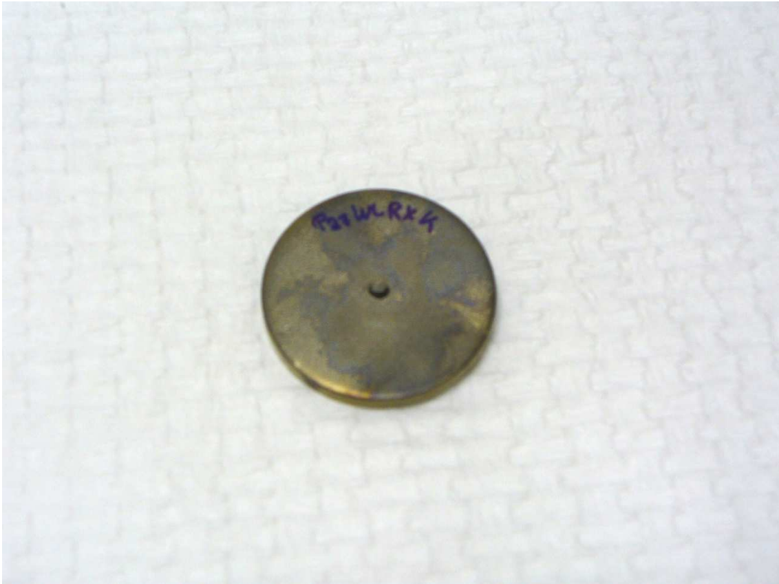
Abbildung 19: Fertig zementierter und beschrifteter Prüfkörper. Man erkennt die marmorierte, durch die Oberflächenkonditionierung der hydrophilen Prüfkörper hervorgerufene Oberfläche.
