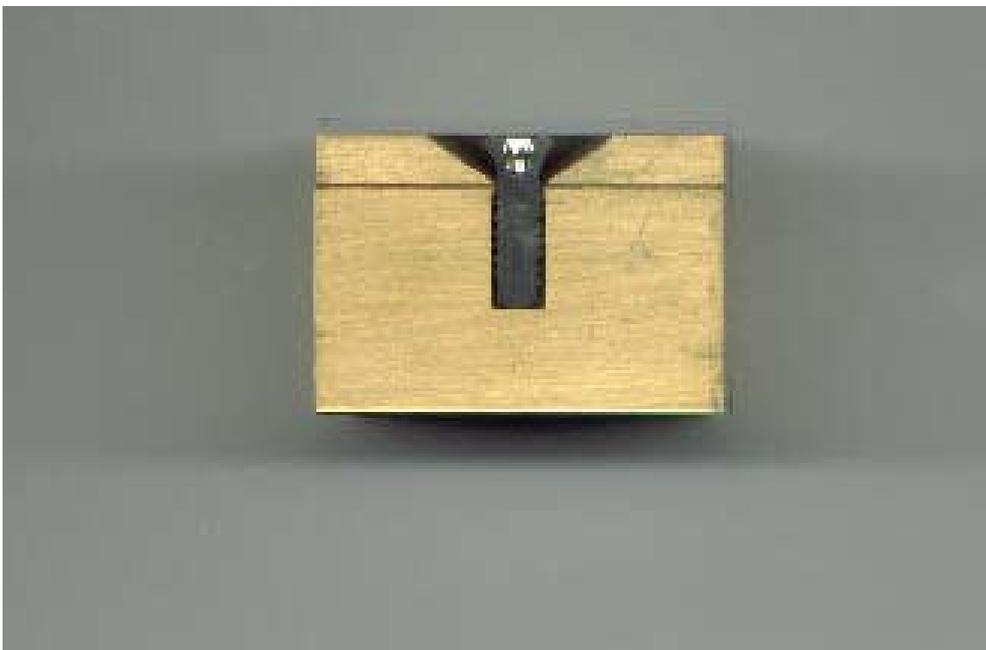
*Abb. 7 Prototyp Frontalsicht: Deckplatte mit Ledervlies und Messingsockel Implantatlängsschnitt mit Manschette, frontale Glasscheibe.*
