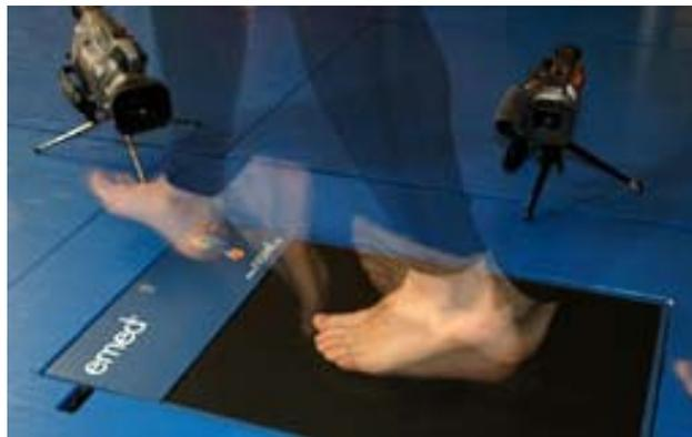
**Abb. 1:** Barfuß-Druckverteilungsmessung (*Emed-Plattform*)
