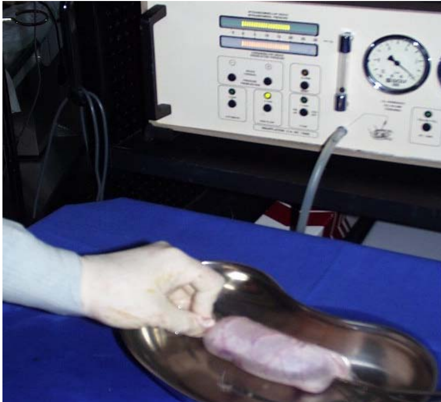
Abbildung 3.2 - Prüfung der Druckdichtigkeit im Wasserbad
