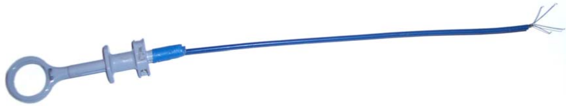
Abbildung 2.29 - Funktionsmodell des NiTi-Greifers (komplette Ansicht)
