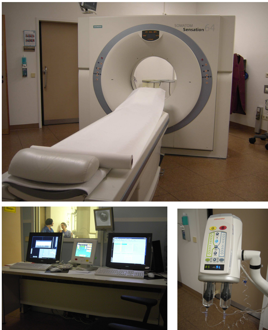
Abbildung 2: 64-Zeilen MDCT (oben) mit Zwei-Kolben Injektionspumpe (unten rechts) und offline Workstation (unten links) in der Abteilung für Radiologische Diagnostik der Universität Tübingen
