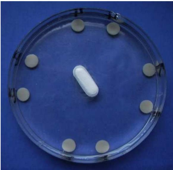
**Abbildung 3: Versuchsaufbau *in vitro*; je zwei Plättchen einer Serie mit Klebewachs fixiert in Petrischale mit Rührfisch**
