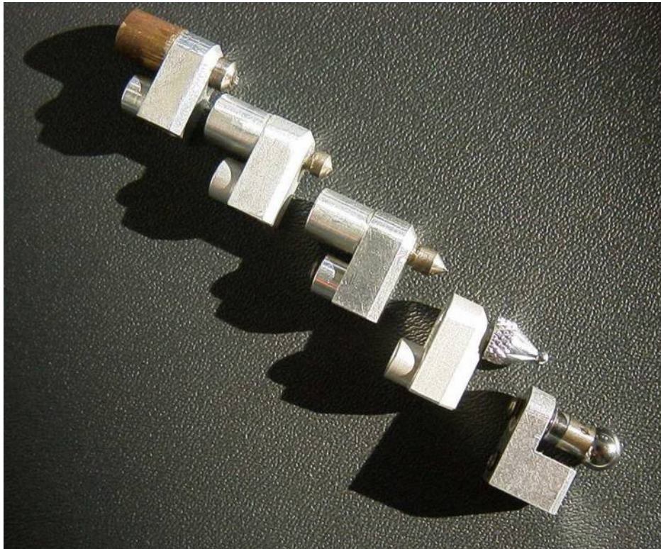
Abbildung 3: Tastspitzen fotografisch (Foto der Firma Innowep) Von links nach rechts: 1. Ritzdiamant, 2. 120°-Diamant, 3. 90°-Diamant, 4. & 5. zwei kugelförmige Eindringkörper
