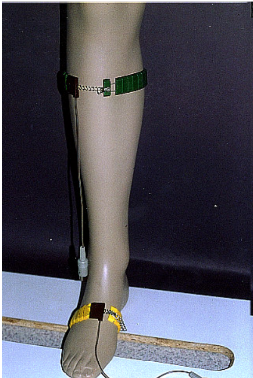
Abb. 8: Exemplarische Darstellung der Quecksilberdehnungsstreifenplethysmographie
