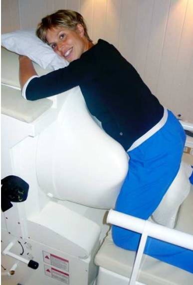
Abbildung 2: Das fMEG-System in der magnetischen Abschirmkammer. Eine Patientin sitzt zur Aufzeichnung auf der an sie angepassten Sitzvorrichtung mit dem Bauch nach vorne in der Sensorenschale. In der Sensorenschale befinden sich gleichmäßig verteilt 156 Sensoren, die die magnetische Aktivität registrieren.
