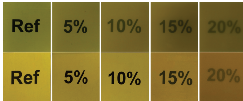
Abbildung 4.1: Beispielhafte Darstellung der Trübung in duroplastischen Polyurethanen auf Basis nachwachsender Rohstoffe. Von links nach rechts wurde das Mischungsverhältnis der Einzelkomponenten so variiert, dass rechts mehr höher polare Substanzen enthalten sind als links. Die 1 mm dicken Proben wurden auf weißem Papier mit schwarzem Schriftzug platziert. Oben ist die A-Reihe dargestellt, unten die S-Reihe.
