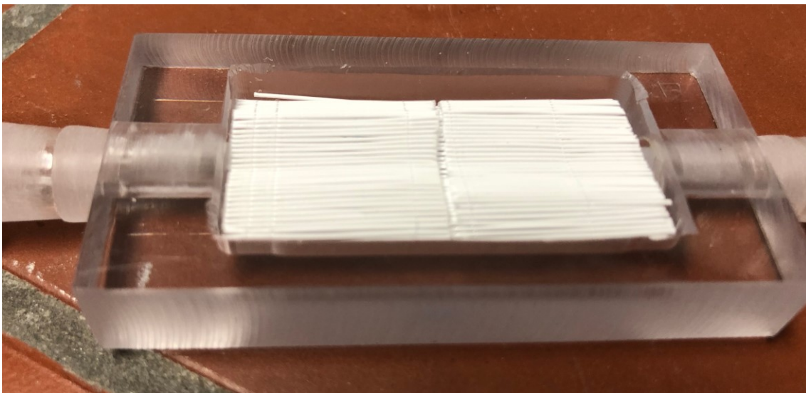
Abb. 6: Unverschlossene Messkammer mit eingelegten PMP-Membranen
