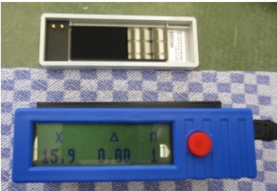
Abbildung 12 positioniertes Glanzmessgerät Picogloss 560 MC-XS nach Probenmessung auf der 3D-gedruckten Vorrichtung mit eingesetztem Prüfkörper. Oben im Bild befindet sich die Kalibrierungsvorrichtung mit einer schwarzen Glasscheibe.
