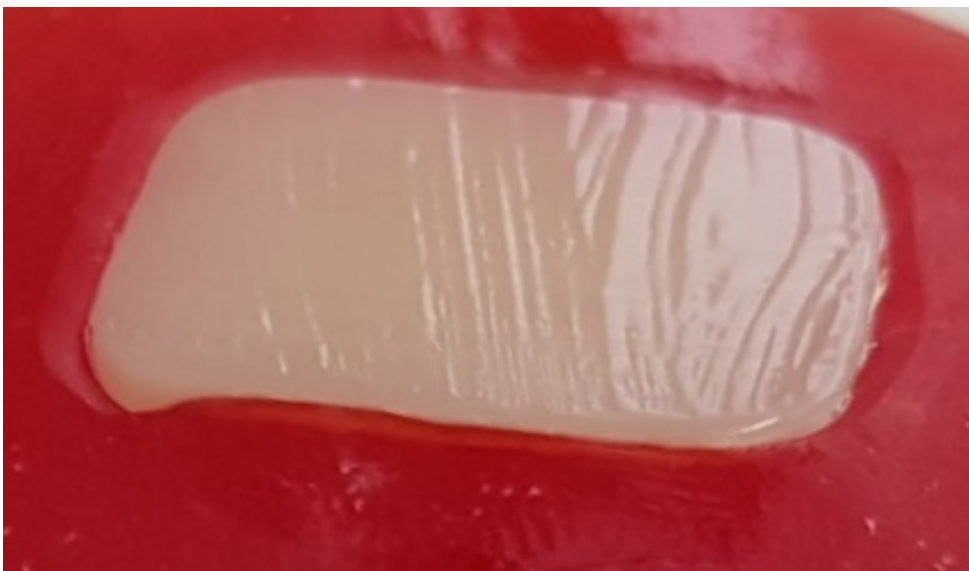
Abbildung 7 Darstellung der strukturierten Oberfläche einer mit Glasur versehenen Celtra Duo Probe nach dem Glanzbrand und nach dem Einbetten in Palavit G®.
