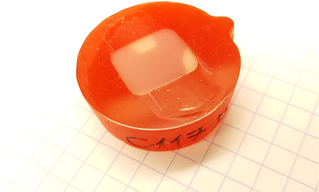
Abbildung 48 polierte Celtra Duo Oberfläche nach der simulierten einjährigen Putzintervention mit der Reinigungszahnpasta Depurdent. Der Abrasive Verlust des PMMA ist am Übergang zur Keramikprobe sichtbar.
