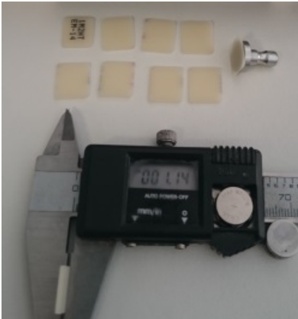
Abbildung 2 getrennte Keramik-Blanks eines Vita CAD/CAM Blanks , Kontrolle der Scheibendicke nach dem Trennen mit einer elektronischen Messlehre.
