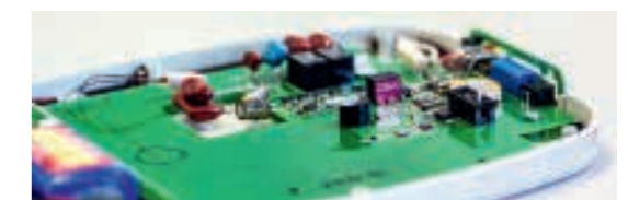
Innenleben eines Funkstreckenverlängerers
