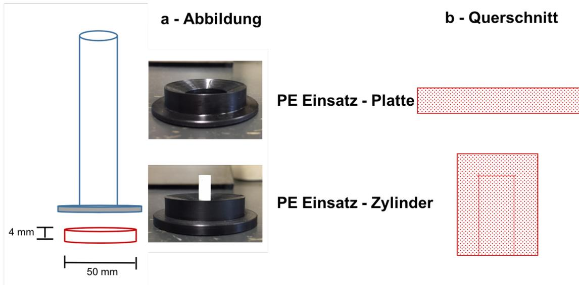
Abbildung 3-2: Anpassung der Aufschäummodule: a: Abbildung; b: Querschnitt
