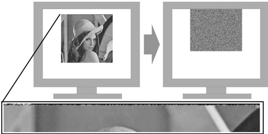
Abbildung 4.7: Darstellung der Scrollproblematik. Ist der Header nicht sichtbar, so ist die Entschlüsselung nicht möglich.
